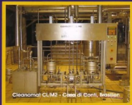
**Halbautomatische Keg-Anlagen für die Befüllung von Kegs von 10 - 50 l.**
